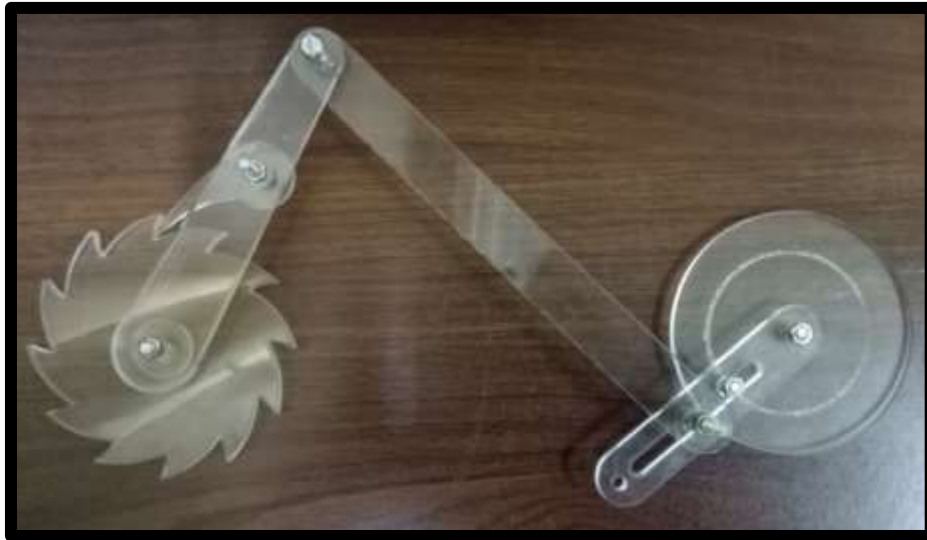
شكل(5)- الشكل مجمع لآليه الترس والسقاطة والمستخدم فعلياً فى الشرح
