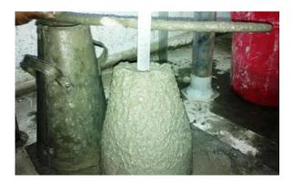
Fig. 6. Slump test
