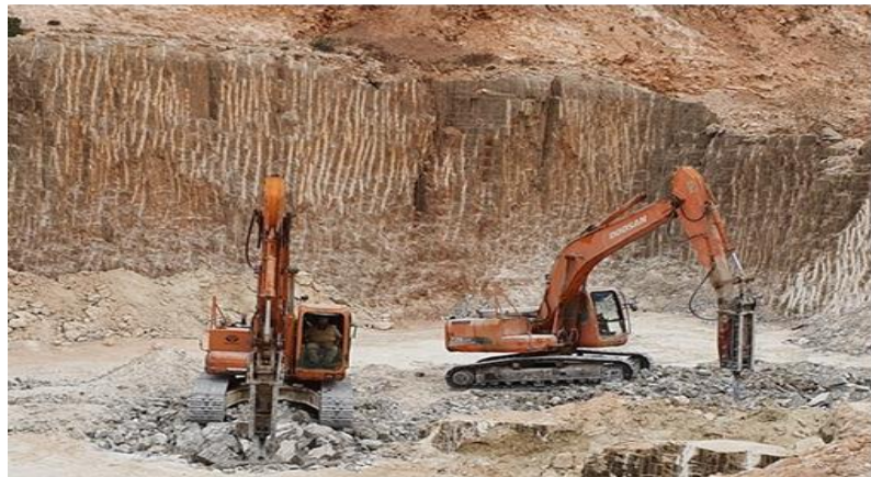
شكل ٩: محجر جبس قرب مدينة الابيار، شمال شرق بنغازي. ويستخدم في صناعة الاسمنت.
