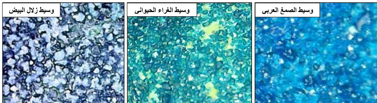
أشكال (٣) توضح بعد تطبيق وجفاف مادة الأخضر المصري في الوسائط اللوني المختلفة، تكبير بالميكروسكوب الرقمي
