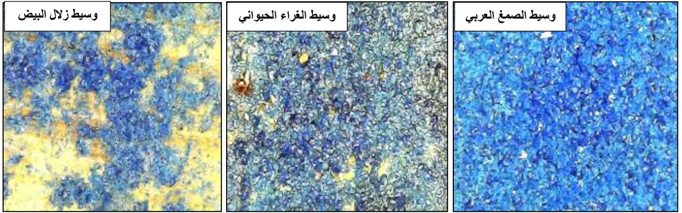
أشكال (٩) توضح الأزرق المصري في الوسائط اللوني وبعد التقادم الحراري ، تكبير الميكروسكوب الرقمي
