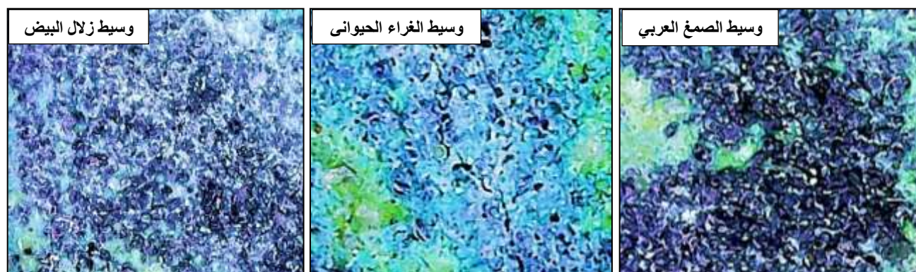
أشكال (٤) توضح مادة الأخضر المصري بعد التقادم الحراري المعجل، تكبير بواسطة الميكروسكوب الرقمي
