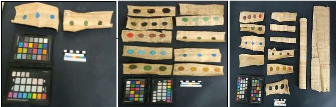
أشكال (٢) توضح أ- بعد الإنتهاء من التقادم الحراري لعينات البردي، بينما تشير ب، ج - بعد الإنتهاء من برنامج التقادم بالدفن لعينات البردي التجريبية
