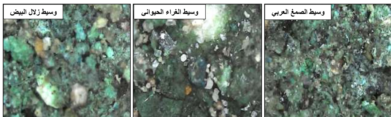
أشكال (٥) توضح مادة الأخضر المصري بعد الانتهاء من التقادم بالدفن، تكبير بالميكروسكوب الرقمي
