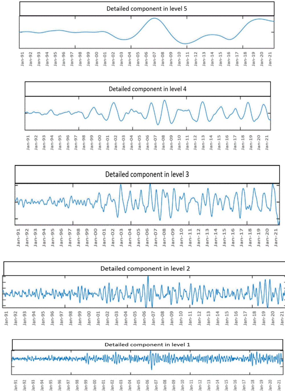
شكل (١٠) يوضح تجزئة السلسلة الأصلية باستخدام التحويل المويجي المنفصل
