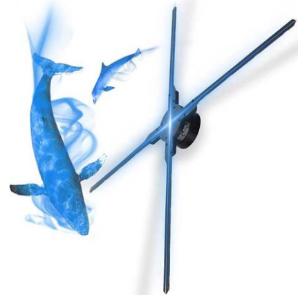
شكل (8) جهاز هولوجرام مروحة عبارة عن أربع شفرات مدمجة بمصابيح LED (TechGuru, 2023)
