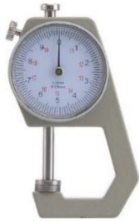
صورة (8) جهاز ميكروميتر لقياس سمك الخامة (تصوير الباحثة)
