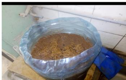
الشكل (8) بعد نقع الليف في هيدروكسيد الصوديوم ثم يتم غسلة
