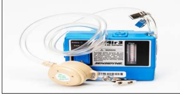
شكل (١): جهاز قياس تركيز الأتربة Air Sampling System
