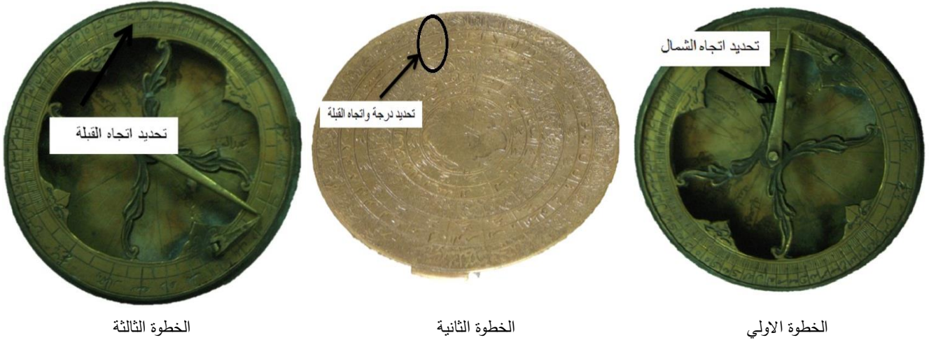
شكل رقم (٨): خطوات تحديد اتجاه القبلة على البوصلة.
