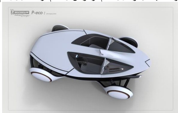
شكل (9) التصميم المقترح للمصمم Jung Hoon Kim لسيارة "P-eco" التي تعمل بالكهرباء الانضغاطية
