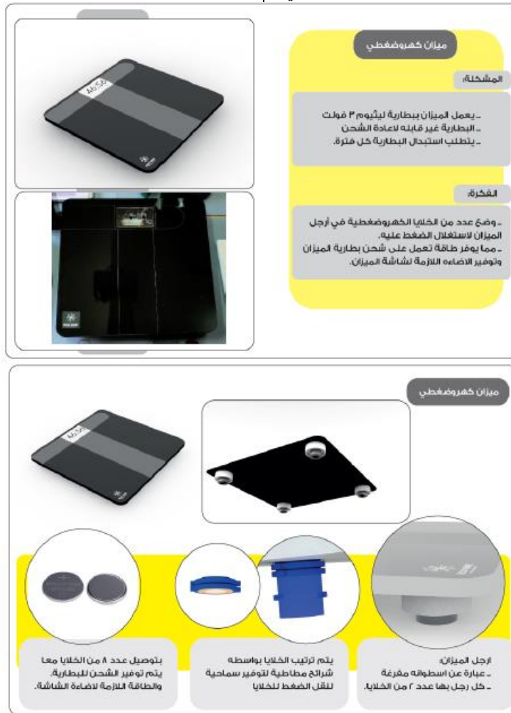
شكل (19) التصميم والنموذج النهائي للميزان الكهروضغطي
