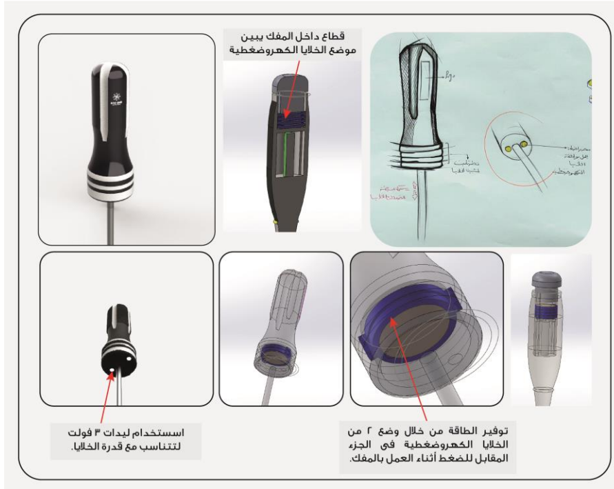
شكل (20) تصميم المفك الكهروضغطي
