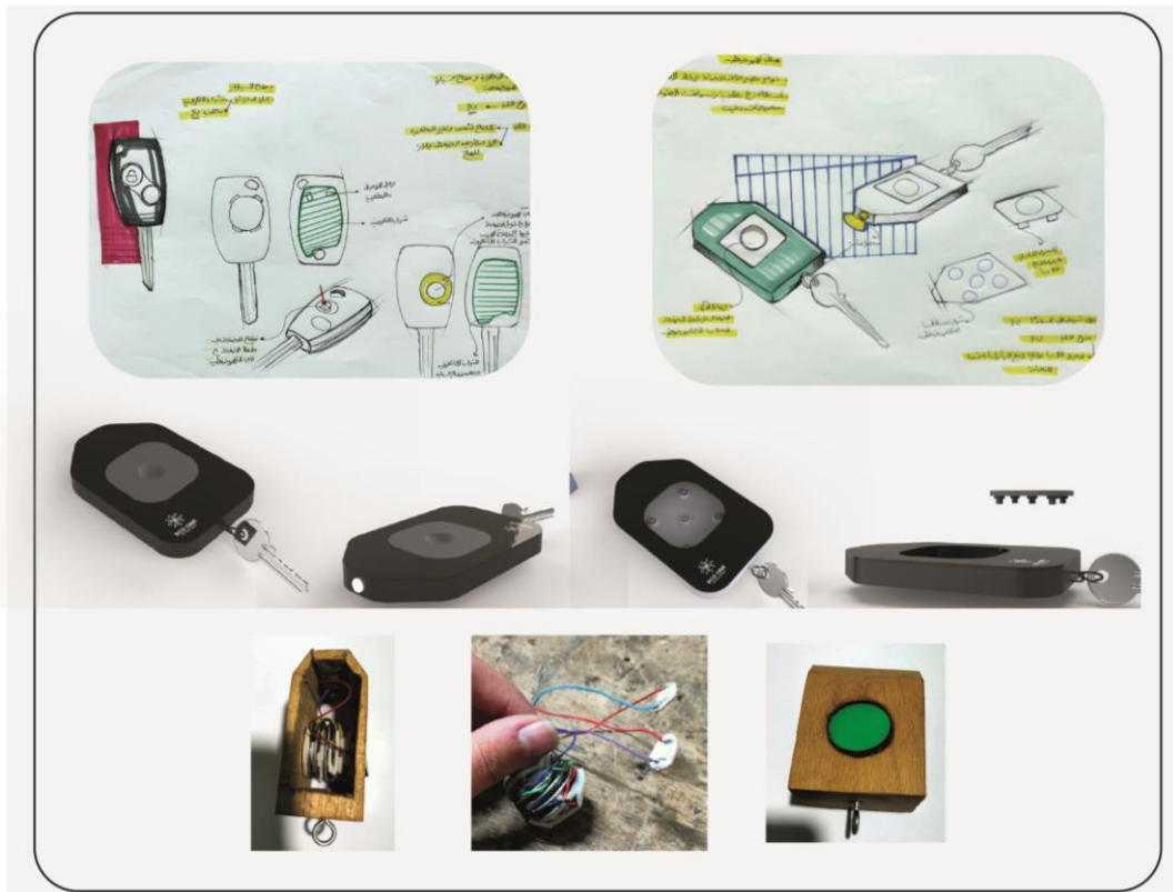
شكل (22) المفتاح اللاسلكي (ريموت) الكهروضغطي للسيارة
