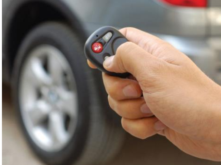
شكل (21) مفتاح السيارة اللاسلكي التقليدي الذي يعمل بالبطارية
