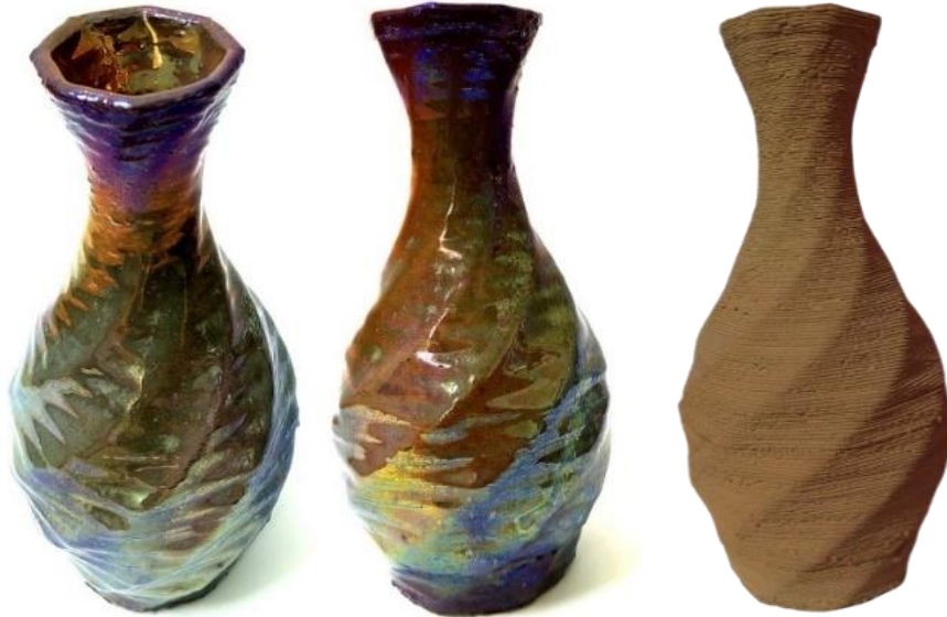
شكل (٢٣): نتائج المعالجة البعدية للنماذج الخزفية ثلاثية الأبعاد المطبوعة.
