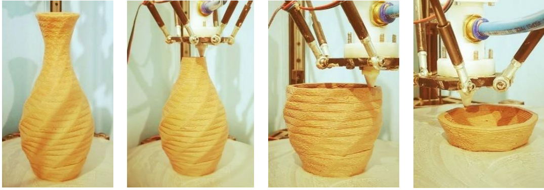
شكل (٢٢): خطوات تنفيذ نموذج خزفي معاصر ثلاثي الأبعاد
