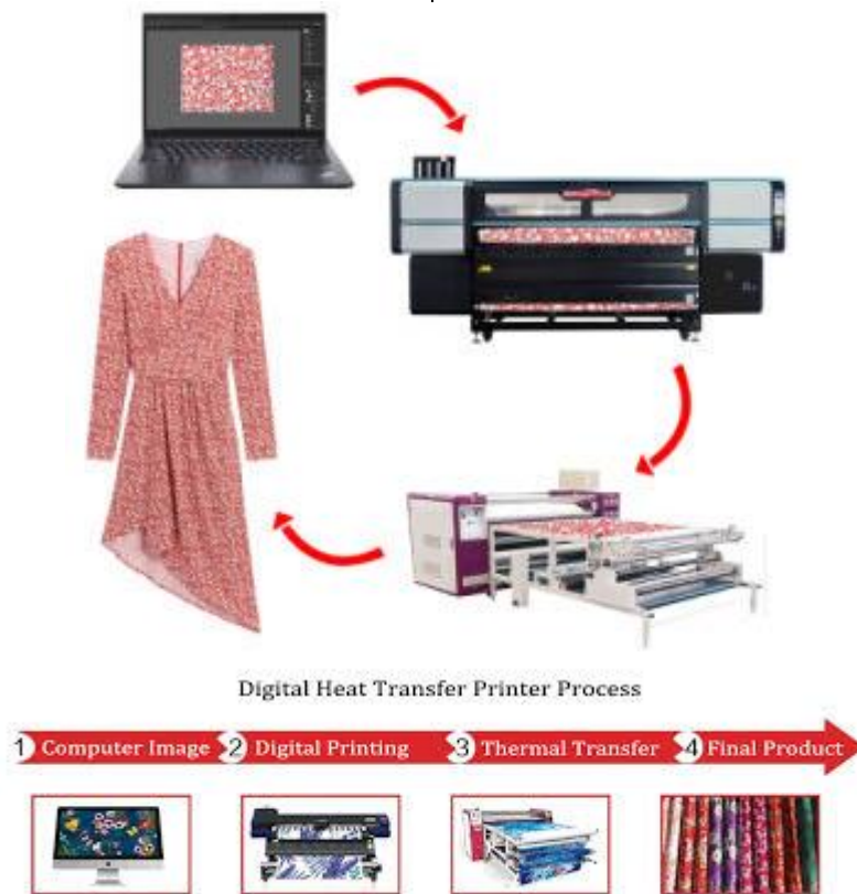
4. المنتج النهائي - 3. الإنتقال الحرارى - 2. الطباعة الديجيتال - 1. التصميم بالكمبيوتر شكل (17) عملية الطباعة الرقمية بالانتقال الحرارى
