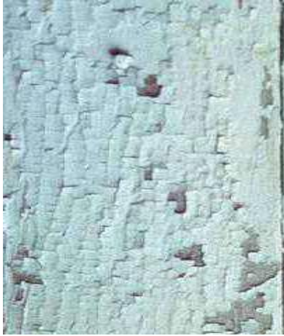
الشكل رقم(١) يوضح الشقوق والإنفصالات فى الحامل الخشبى
