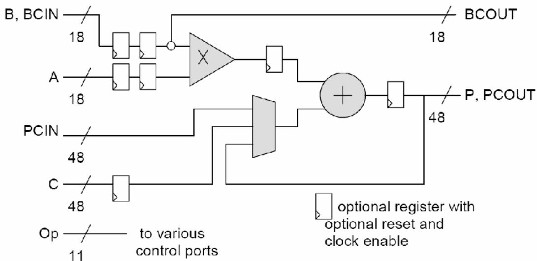
**Figure (4): DSP48 slice in Xilinx Virtex 4 FPGA**
