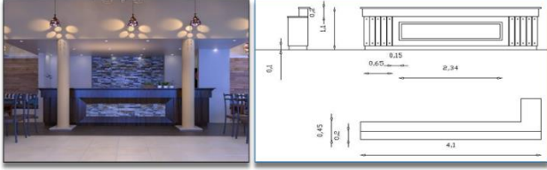
شكل (21) تصميم الكاونتر بشاقتيريا - من الخشب والتصميمية بأحجار العايشة
