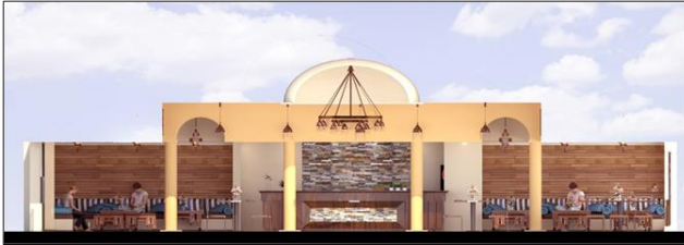
شكل (10) قطاع طولي مار بالكافيتيريا يظهر الجانب الغربي المغطى على الكاونتر والجلسات الثابتة
