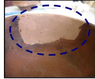
صورة رقم (18) توضح التطبيق بعد التقوية والاستكمال من الداخل
