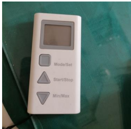
شكل (٤) الجهاز المستخدم لقياس درجة الحرارة داخل وخارج الصوبة الزراعية
