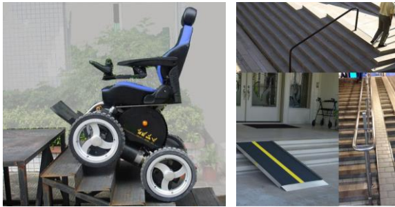
شكل (٨) - أحد الحلول المقترحة لحل مشكلة صعود الكراسي المتحركة على السلالم.
