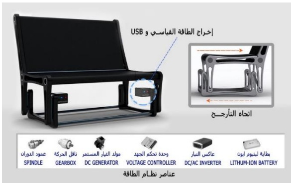
صورة (٣) كرسي متأرجح يحول الطاقة الحركية الى كهربائية (Yoneda, 2010), (Burns, 2009)
