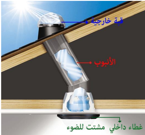
شكل ( 15 ) يوضح المكونات الداخلى للانابيب الشمسية وتوزيعها للضوء
