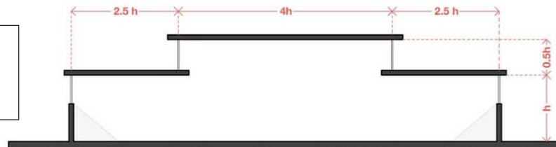
شكل ( 11 ) يوضح الفتحات السقفية الافقيه و كيفية استقبالها للضوء و توزيعه داخل الحيز
