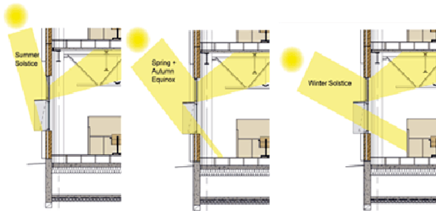
شكل ( 13 ) يوضح الاسطح العاكسه وفكره عملها في تحقق الاستفاده من الضوء الطبيعي
