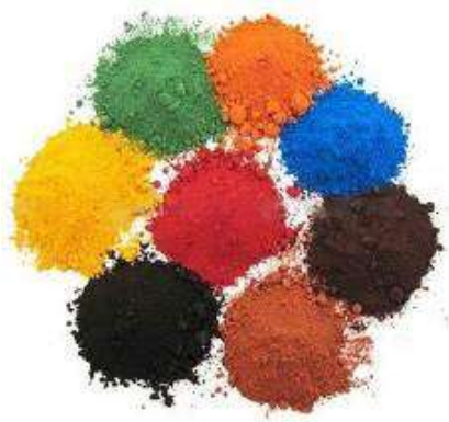
شكل رقم ( 6 ) بعض عينات الصبغات اللونية غير العضوية المستخدمة في خلطات أخشاب WPC
