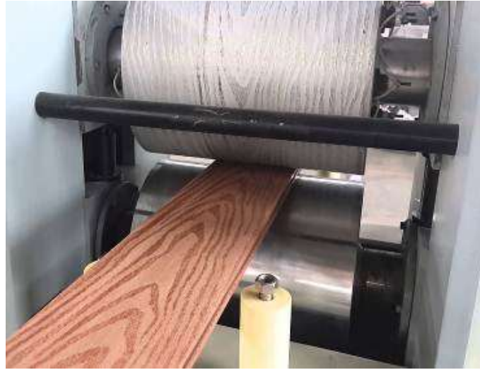
شكل رقم ( 9 ) ماكينة عمل تجازيع الخشب الطبيعي Embossing Machine
