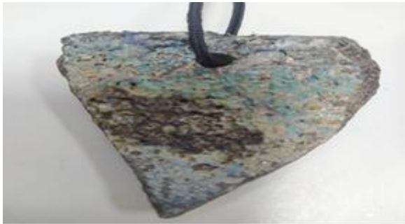
صورة رقم (13) كسر صينى وسيراميك مطبق عليها جليز ملحي
