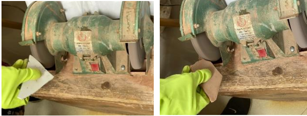
صورة رقم (2) توضيح لتهذيب الفخار والصينى على حجر الجلخ
