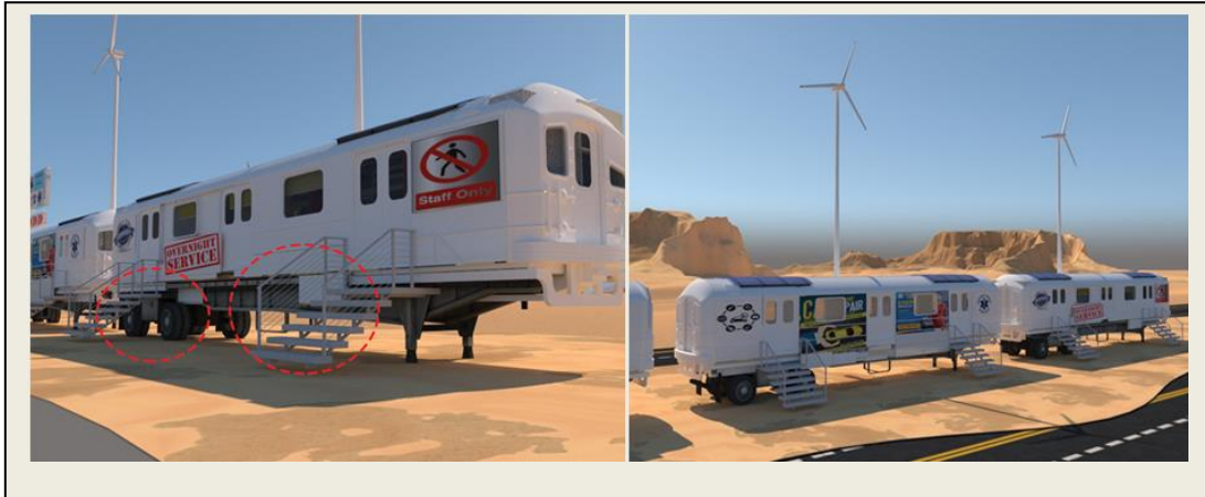
شكل (4) يوضح إحلال عجل عربات القطار بعجل عربات المقطورات لسهولة نقلها من مكان لآخر ، أيضا السلم الخارجي لسهولة الصعود للعربات .
