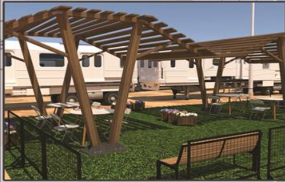
شكل (٥٢) لقطة خارجية توضح منطقة الكافيتريا و استخدام البرجولات الخشبية سهلة الفك و التركيب مع اسوار خفيفة متحركة منفصلة .
