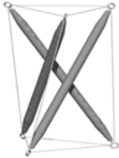
شكل (15) يمثل هيكل التوتر البسيط مكون من ثلاث دعامة وثلاث كابلات
