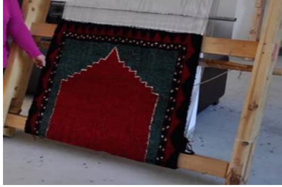
صورة رقم (٣٧) توضح استخدام النول الخشبي في نسج السجاد اليدوي
