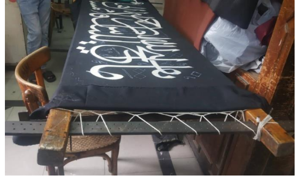
صورة رقم (١٦) توضح المنسج أو النول المستخدم في شد قماش التطريز (ورشة أحمد القصبجي)
