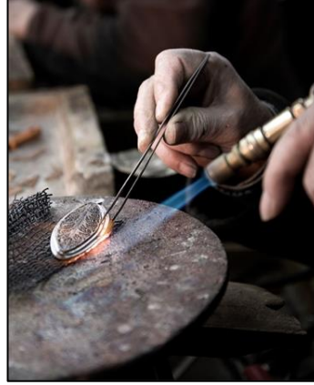
صورة ( ٤ ) توجيه البوري لاجراء عملية اللحام علي شبكة من الحديد "البستأ" لضمان عملية رص الحشوات
