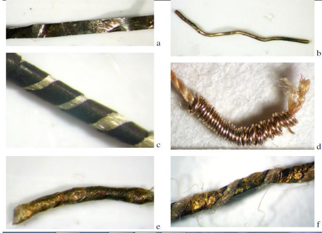
صورة رقم ( ١٣ ) توضح أنواع الخيوط المعدنية: a شريحة معدنية - b سلك معدني - c شريحة معدنية ملفوفة حول ألياف من الحرير - d سلك حلزوني ملفوف حول ألياف - e طبقة رقيقة من الذهب حول الألياف - f شرائح من الجلد
