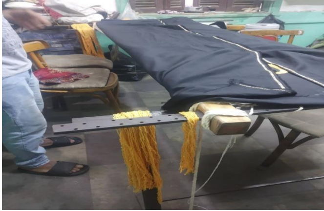
صورة رقم ( ١٨ ) توضح طريقة شد القماش على المنسج (ورشة أحمد القصبجي)
