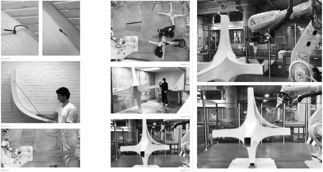
شكل (26) يوضح انتاج العنصر الإنشائية بالمقياس الحقيقي باستخدام Robot (Automated manufacturing) النمذجة من الوسط الرقمي الى الوسط المادي باستخدام باستخدام منظومة CAM
