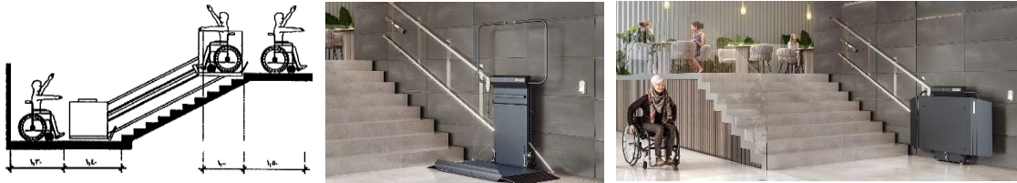
شكل (١٤) يوضح تفاصيل الروافع الكهربائية و نموذج لاحدها في احدي الفنادق. (lehner-lifttechnik, 2023)
