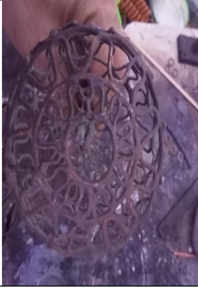
مرحلة تجميع الشكل النهائي بلحام الفضة
