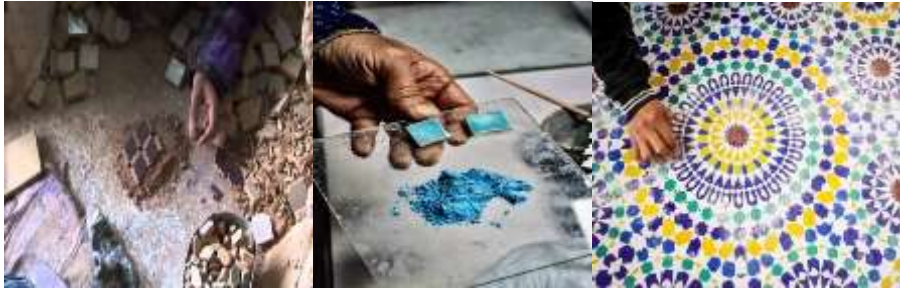
صورة (1) طريقة تصنيع الزليج وتلوينه ولصقه (wep:24)
