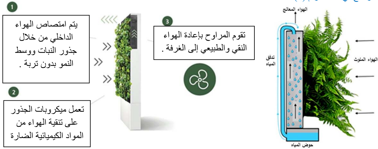
شكل رقم (5) يوضح الفلتر الحيوي في البيئة الداخلية.
