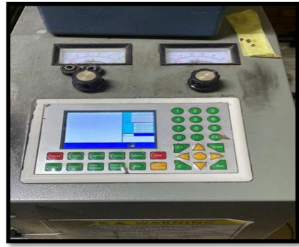
صورة (٣) جهاز الحاسب الآلي المتصل بماكينة القص بالليزر
