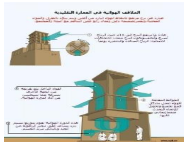
شكل (٩): الية عمل الملفف الهوائي
