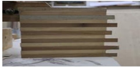
شكل (٢١) عملية الوصل بين أنواع الاخشاب
