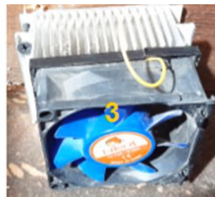
3- The radiator fan
