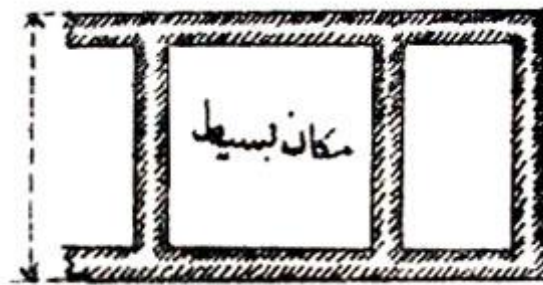
(شكل ٣) مسقط أفقي لتخطيط الحجرات من نوع المكان البسيط داخل الثكنات أو القشلاقات العسكرية (عن مخطوط المطالع القمريّة في الأبنية العسكريّة - مكتبة المتحف الحربي بقلعة صلاح الدين الأيوبي بالقاهرة)
