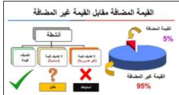
شكل (1) يوضح أنواع النشاطات وعلاقتها بإضافة قيمة للمنتج، بهدف الاحتفاظ بها أو التخلص منها.
