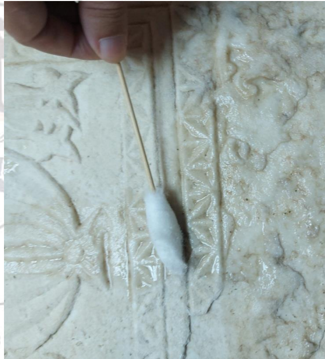
صورة رقم (13) توضح نتيجة استخدام محلول P4 في تنظيف البقع الزيتية على لوجه الأول للوحة الرخامية الأثرية
