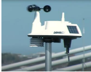
شكل (٢٤) مستشعرات سرعة الرياح على سطح ساحة كروك بجامعة مدينة دبلن [٣٩]
