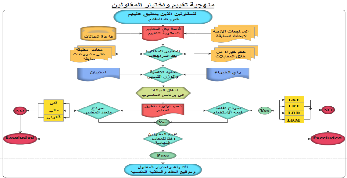
شكل رقم (1) يبين المخطط التدفقي لمنهجية تقييم واختيار المقاولين
