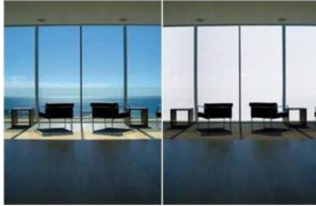
شكل (9) يوضح تغيير شفافية الزجاج الذكي باختلاف الإضاءة https://ntact.com/applications/smart-glass
