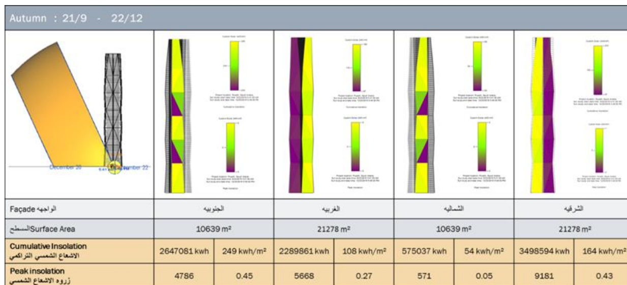
رسم توضيحي 22 : التحليل الشمسي لواجهات برج هيئة سوق المال بالخريف (المصدر الباحث)
