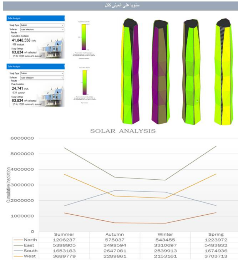
رسم توضيحي 24 : التحليل الشمسي للواجهات الاربعه المختلفه ببرج هيئة سوق المال (المصدر الباحث)
