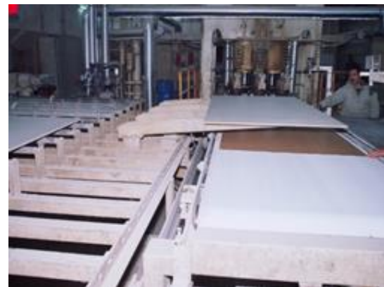
صورة (١٥): مصنع شركة النصر لانتاج الخشب الحبيبي من ساس الكتان بالدقهلية. (شركة طنطا للكتان والزيت، ٢٠١٦)
