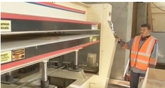
صورة (13): ماكينة ضغط لكبس جريد النخيل بمصنع جريد. (Small Projects، 2022)
