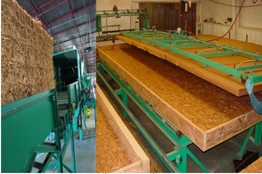
صورة (12): إعادة تدوير قش الأرز لانتاج الألواح الصلبة المستخدمة في البناء والفصل بين الحيزات الداخلية. (Material Strategies، 2012)
