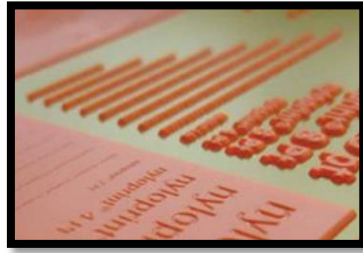
شكل (٣) طريقة البلمرة للطباعة الحرارية (الرفاعي، محمد، ٢٠٢٠)
