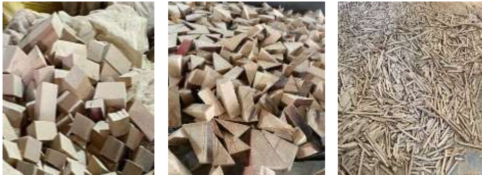
شكل 5 يوضح صورة لتصنيف هالك الاخشاب الناتجة من عمليات تصنيع مختلفة طبقا للحجم والهيئة. (تصوير الباحثة)
