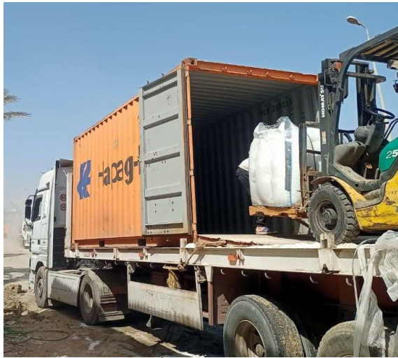
توضح الصورة رقم (4) شكل بالمنصات النقالة pallets، كما توضح الصورة رقم (5) دور منصات النقل أثناء عمليات تحميل الحاوية، المصدر: تصوير الباحثين
