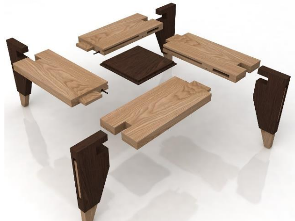
والصورة رقم (38) منظور يوضح طريقة التجميع للقطعة المصدر: رسم الباحثين.
