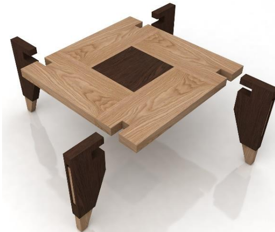
والصورة رقم (37) توضح منظور لطريقة تجميع الارجل مع القرصة للقطعة المصدر: رسم الباحثين.
