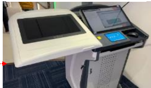
صورة 11: منصة المحاضر مجهزة بادوات التحكم في الشاشات والصوت والتوصيلات والاضاءة المصدر: مرجع سابق
