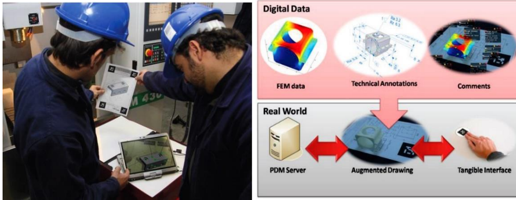
شكل رقم (11) يوضح الرسومات الفنية المدعمة بتقنية الواقع المعزز في مراحل التصميم المختلفة وإعدادات لعمليات الإنتاج
