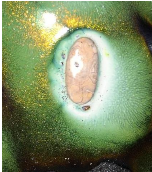
شكل (8) تجربة ذاتية للدراسة تأثير الحرارة على لون الحجر فقد تحول لون حجر العقيق اليمني الاحمر الى البني الفاتح
