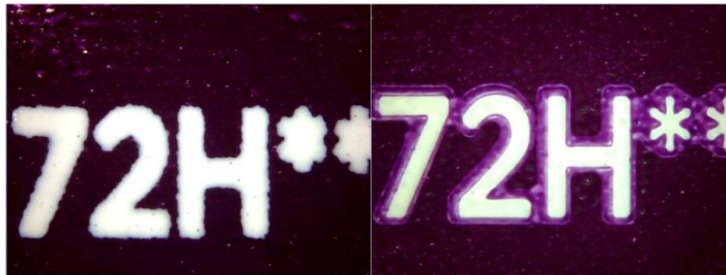
طباعة الفلكسوجراف طباعة السلك اسكرين شكل (8) الفرق في حدة المطبوع الناتج لكل من طباعة الفلكسوجراف والطباعة المسامية
